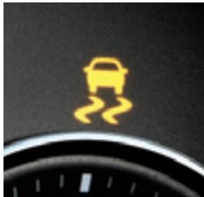
La régulation du comportement dynamique ESP entre en action chaque fois que le véhicule menace de quitter sa trajectoire. Les capteurs du système sont capables de détecter très tôt les situations dynamiques délicates. Lorsqu'une roue se met à patiner ou menace de perdre le contact avec le sol, l'ESP la freine pour stabiliser le véhicule et adapte, si nécessaire la puissance moteur.
